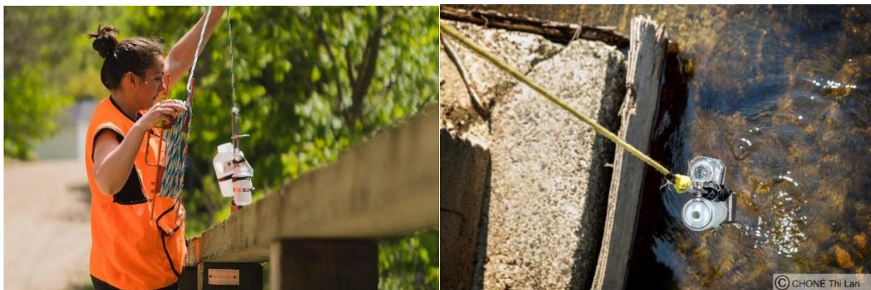
Figure 3 : Prélèvement d'échantillons à l'aide d'un porte-bouteille
